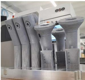
*Prototypenteile aus AlSi10Mg*
